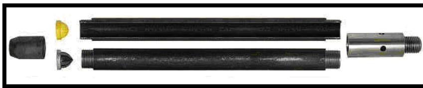
Ilustración 3. Muestreador estándar o cuchara partida (Split Spoon) utilizado durante la realización del ensayo de penetración estándar (SPT).
